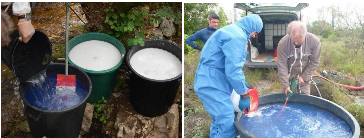
Figure 16 : Préparation de l'acide amino G pour injection à la perte du Glouglou (traçage Nord Vogüé, 10/06/2015) et à l'aven de Fontgraze (traçage Saint-Alban-Auriolles, 10/05/2016)
