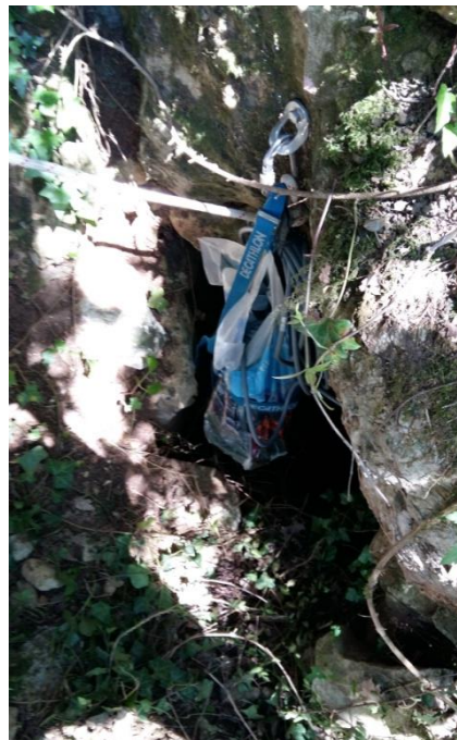
Figure 104 : Boîtier d'acquisition de la sonde du fluorimètre en surplomb de l'entrée de l'aven Fontenille.
