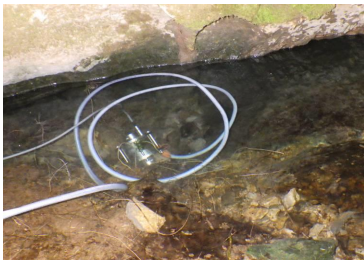
Figure 18 : Fluorimètre GGUN installé au Ranc d'aven (traçage Saint-Alban-Auriolles)
