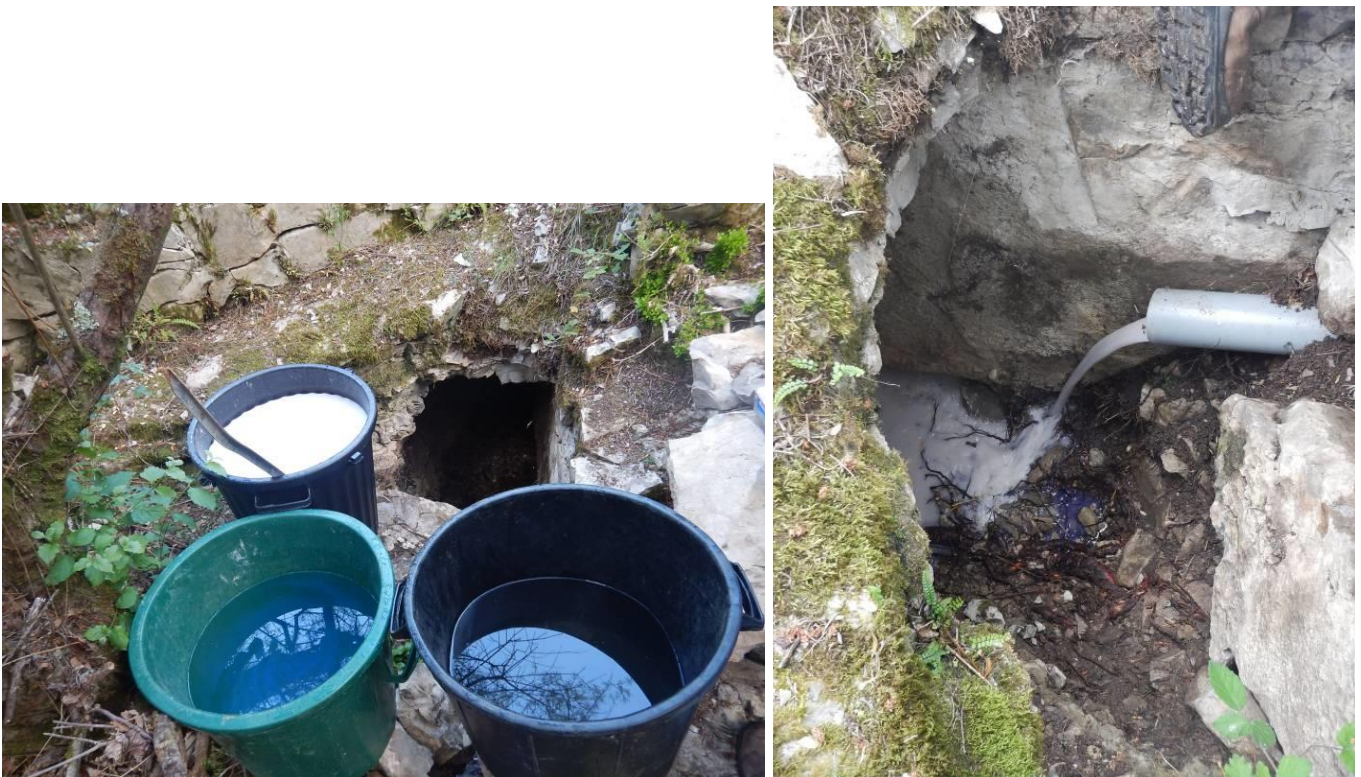
Figure 37 : Photographies prises lors de l'injection de l'acide amino G à la perte du Glou-Glou (10/06/2015)
