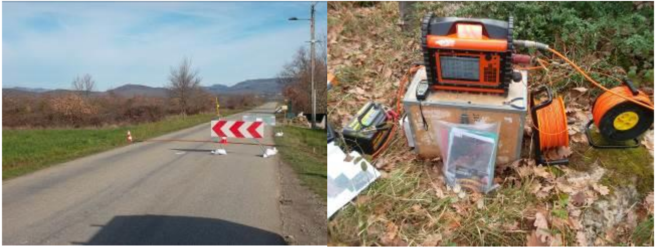
Figure 8 : mise en œuvre de la campagne géophysique - contraintes pour la traversée de la RD avec signalisation routière et feux de chantier – résistivimètre (appareil de mesure) sur site en cours de mesure
