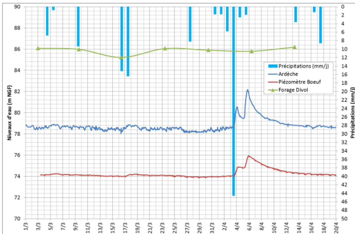
Figure 59 : Evolution des Niveaux d'eau de l'Ardèche et de l'aquifère karstique (piézomètre du Bœuf et forage Divol)
