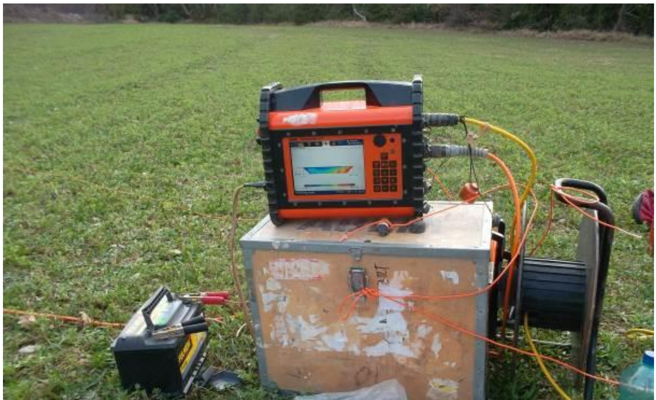
Figure 9 : mise en œuvre de la campagne géophysique - détail de l'écran du résistivimètre avec les résistivités apparentes apparaissant en coupe 2D au cours de la mesure
