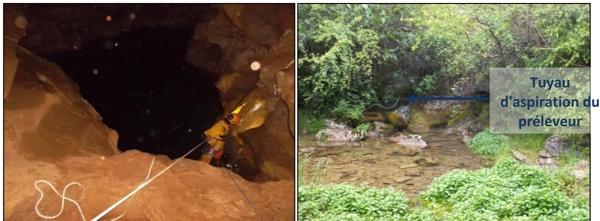
Figure 101 : Installation du fluorimètre dans le siphon de Bourbouillet (à gauche) et du préleveur à l'exutoire de la source (à droite)
