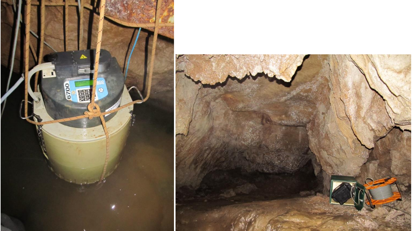
Figure 38 : Photographies des systèmes de surveillance (préleveur automatique et fluorimètre installés aux sources du Pontet)
